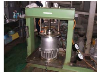
フット弁耐圧試験
