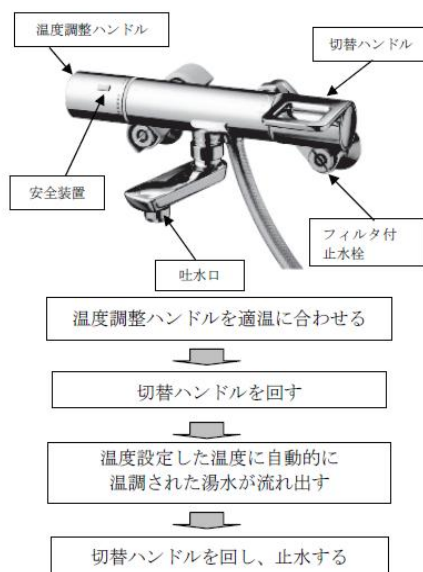
図 81. サーモスタット湯水混合水栓の名称と作動原理
