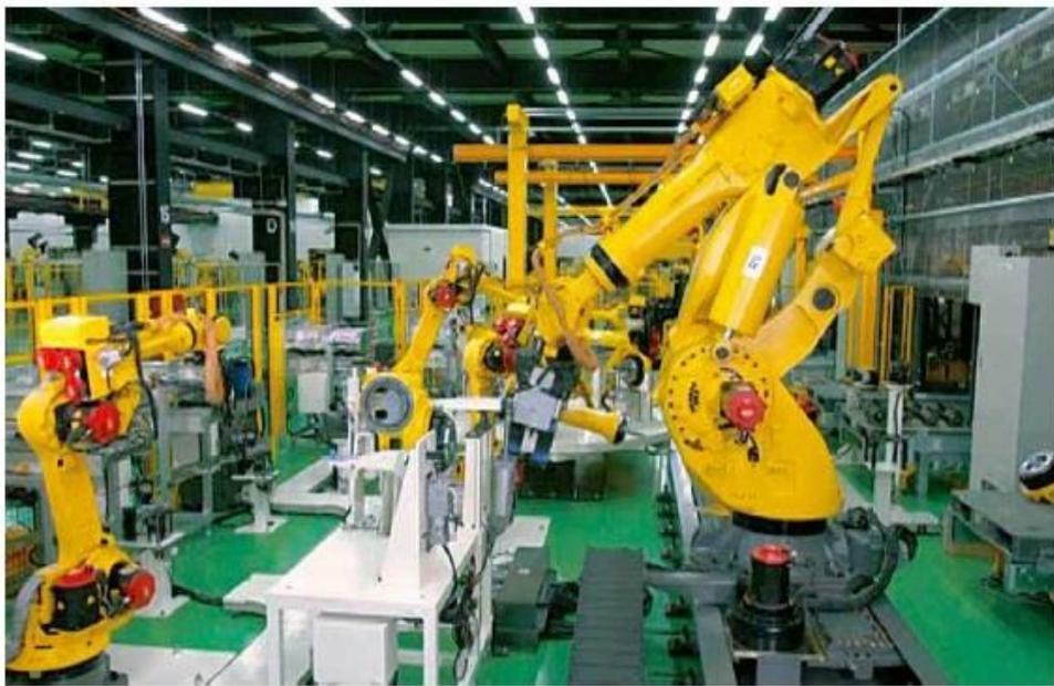
④ **機械加工工場** (多品種少量加工ライン。ロボット・ロボドリル・ロボショット・ロボカット・レーザの部品を加工しており、夜間・週末を含む長時間の無人運転を実施。工作機械・ロボットの稼働モニタを活用した設備の稼働率向上、精度変化の把握による加工不良の削減、また、工場環境を維持するためのミスト量・温度・照度の見える化も実施)
