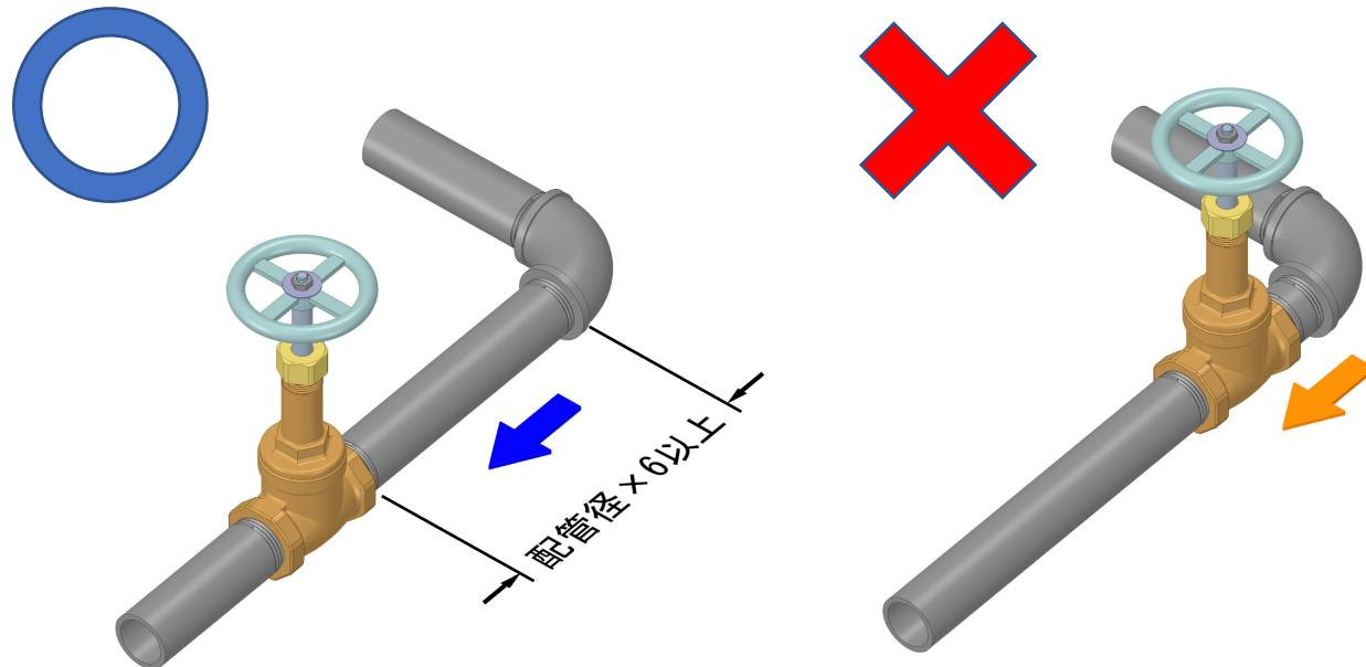
バルブをエルボの下流側に配管する時は、配管径の6倍以上の距離をとって配管してください。振動でバルブが破損する恐れがあります。
