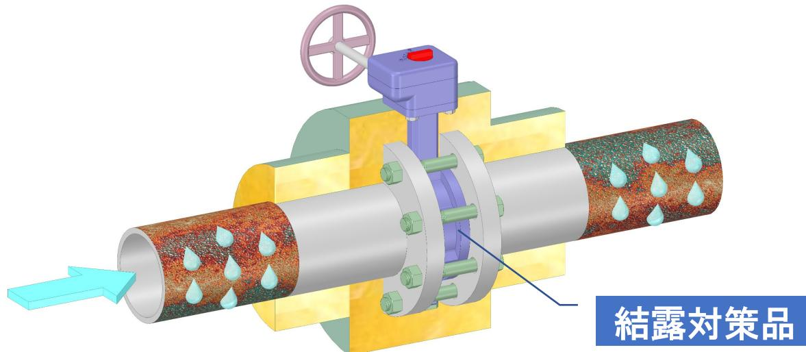
結露による腐食を防止するため、適切な保温対策をとるか、または、結露対策を講じたバルブを選定してください。
