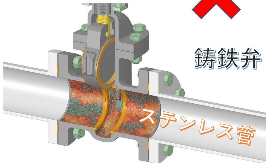
ステンレス鋼管には、ステンレス製バルブをお使いください。ただし、青銅製バルブは接続可能です。
