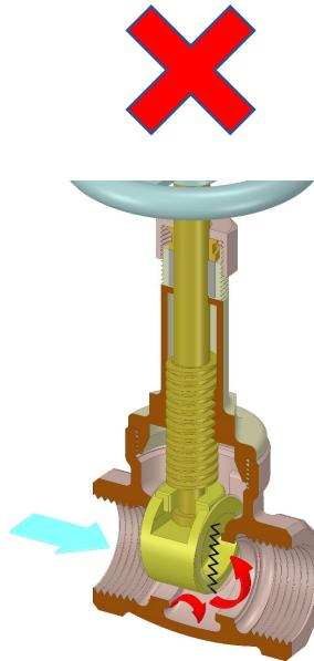
ゲート弁は中間開度で長時間保持した場合、脈動、エロージョン（浸食）により弁座面が損傷を受けることがあります。
